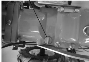
1. Ábra – Hajtóműolaj-szint ellenőrzése
