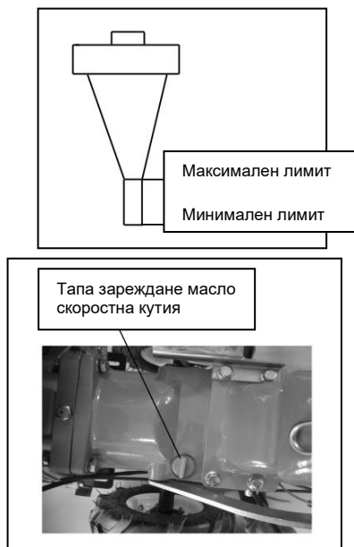
Фиг. 5 – Проверка на нивото на трансмисионното масло
