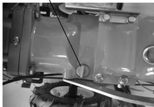
Fig. 5– Verificarea nivelului de ulei transmisie
