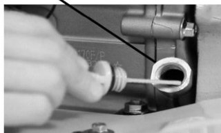
Fig 5a - Verificare ulei motor
