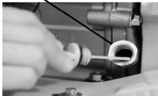
5a. Ábra – Motorolajsztint ellenőrzése
